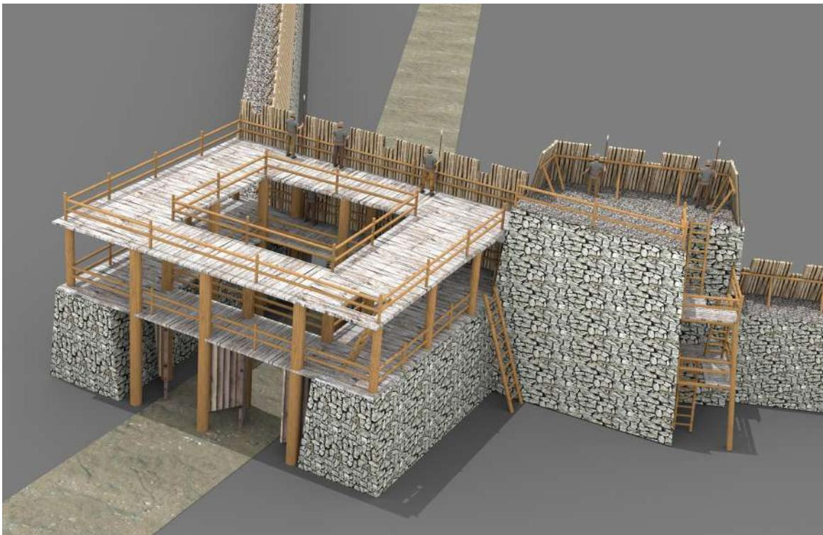
Fig. 53 : Gergovie, porte sud. Restitution graphique de la porte sud et de la tour TR 26/27, vue de l'intérieur. La cage d'escalier est intégrée dans l'angle nord-ouest de la tour. (Modèle 3D: Lucien Andrieu).
